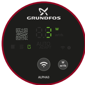
Abb. 27 Bedienfeld im Betrieb mit Konstantkennlinie
