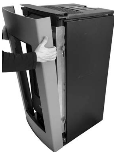
Fig. 45 - Entfernen die Rahmen
