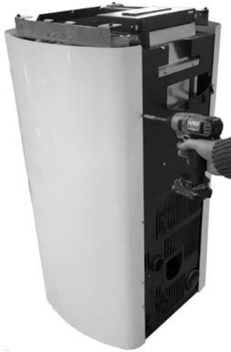
Fig. 47 - Hintere Schrauben entfernen
