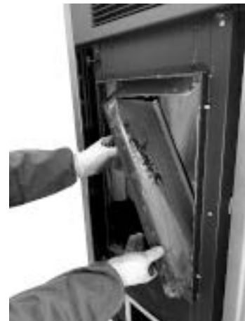
Fig. 91 - Die Seitenwände entfernen
