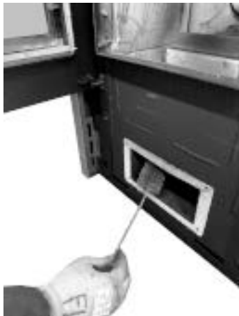
Fig. 84 - Mit einer Rohrreinigungsbürste reinigen
