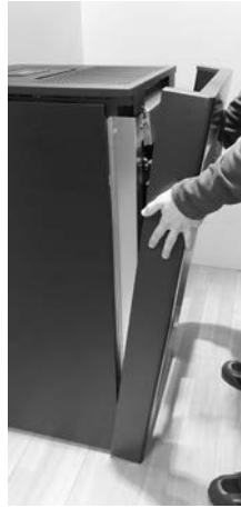
Fig. 25 - Entfernen die Rahmen
