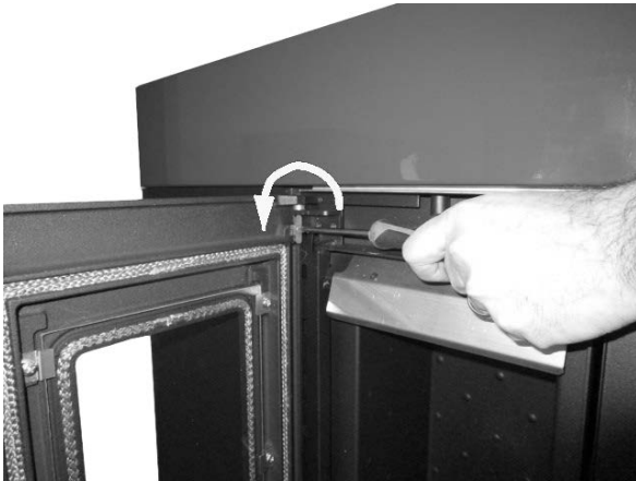
Fig. 19 - Entfernen der Schrauben
