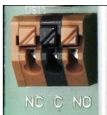
Abb. 4: Sensorbox: Detail des internen Klemmenbrettes
