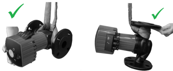
Abb. 1: Sachgerechter Transport der Pumpe
