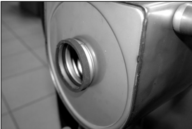
Abb. 9: Moosgummidichtung um die Muffe des Wärmetauschers kleben.
