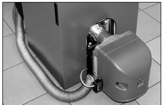
Abb. 12: Zuluftschlauch am Brenner anschließen. Für Wartungszwecke kann der Schlauch zusammen mit dem Zuluftstutzen des Brenners aus dem Luftkasten gezogen werden.
