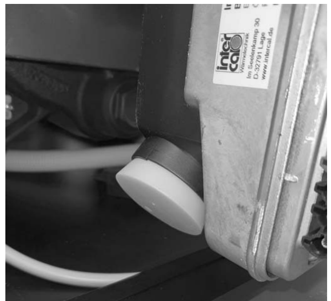
Abb. 8: Zuluftstopfen im Ansaugschalldämpfer
