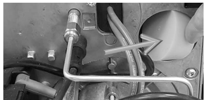
Abb. 10: Einsetzen des Silikon-Stopfens
