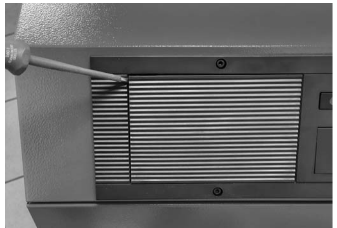
Abb. 28: Demontage der Blindabdeckung
