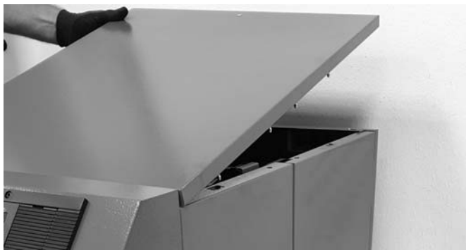
Abb. 79: Demontage der oberen Verkleidung
