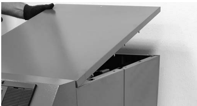
Abb. 26: Demontage des Verkleidungsdeckels
