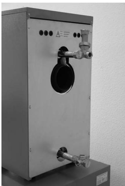
Abzweigstücke auf die Gewindenippel montieren.
