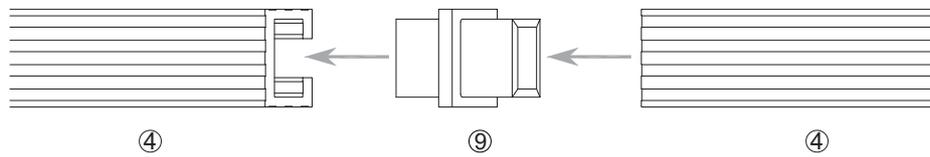
Schienenwerbindungs stück ⑨ ins beide Montageschiene ④ rein schieben.
