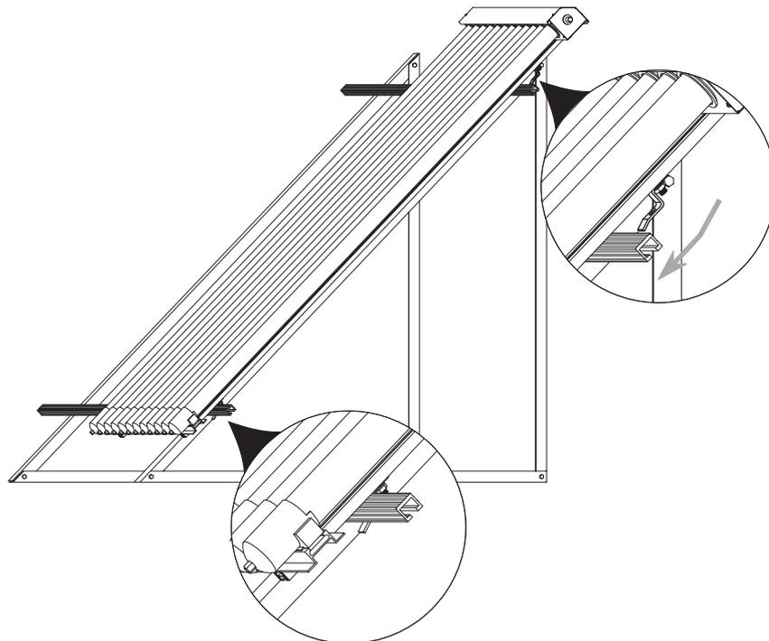
Kollektoren auf die Montageschiene dann obere Haltehaken nach unten schieben und dann fest zuziehen.
