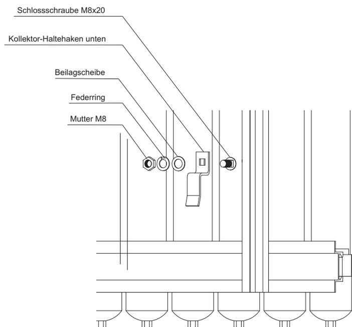
Unteren Kollektor-Haltehaken einbauen mit Schloßschraube M8x20 und fest zuziehen.
