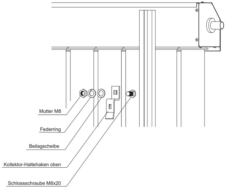
Oberen Kollektor-Haltehaken einbauen mit Schloßschraube M8x20 und leicht zuziehen.
