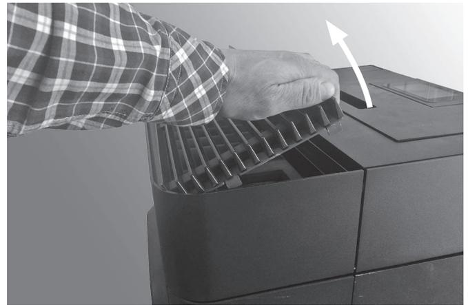
Der Brennraumdeckel bildet den Abschluss des Brennraums nach oben. Er muss demontiert werden, um die Reinigung der Heizgaszüge zu ermöglichen.
