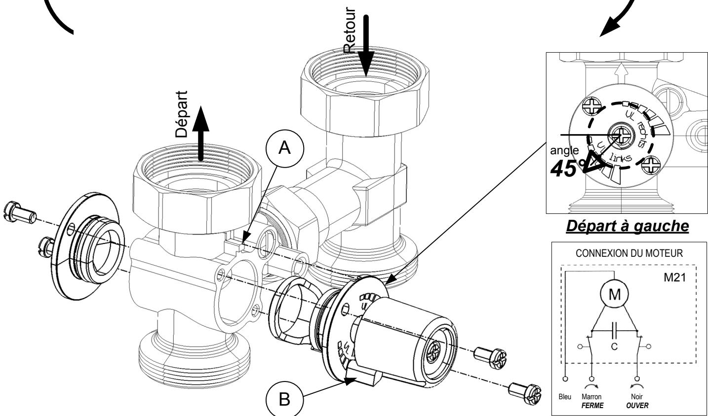
(A) - Placez de façon correcte l'arrêt sur le corps de la vanne mélangeuse avec le siège sur le couvercle indicateur de la poignée.
