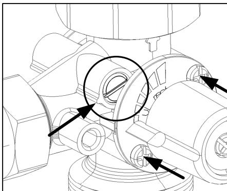
Les flèches montrent la référence du by-pass en position tout ouvert et les vis de fixation du couvercle indicateur et de la tige de réglage.
