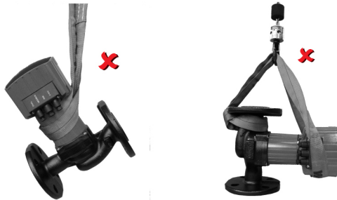
III. 2: Transport non conforme de la pompe
