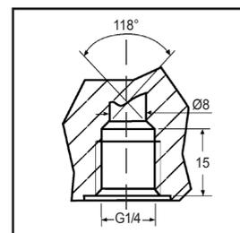
Zulauf ① und Rücklauf ② mit Direktverschraubung (Abdichten mit Flachdichtung auf Ansenkung möglich)
